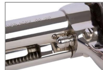
Dettaglio del tubo di espulsione, della molla e della testa del perno della base del cilindro.
